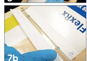
Lorsque le bord plié de l'étiquette est bien aligné sur la perforation de la plaquette, maintenez la position de l'étiquette au milieu du plateau d'une main, puis utilisez l'autre main pour plier la partie supérieure de l'étiquette vers le plateau (8a). Passer fermement un doigt par-dessus la zone adhésive de l'étiquette pour joindre le dos du couvercle à la collerette supérieure de la plaquette. (8b)
