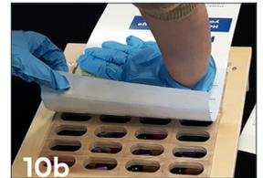
À l'aide du rouleau, appliquer une pression ferme et constante dans un mouvement horizontal sur l'ensemble de la plaquette et sur le dos du couvercle afin de s'assurer qu'un joint solide est présent sur toute la surface. (11)
